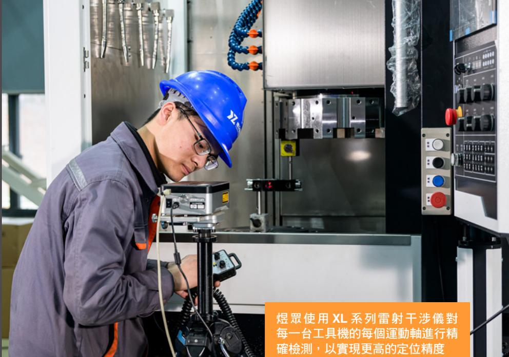
煜眾使用 XL 系列雷射干涉儀對每一台工具機的每個運動軸進行精確檢測，以實現更高的定位精度
