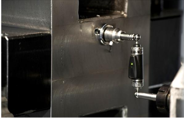
安裝在 Spirax Sarco 工具機上的循圓測試儀
