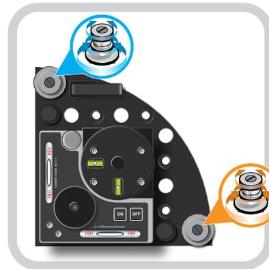
可使用俯仰角／扭擺角調整器調整傾斜板。
