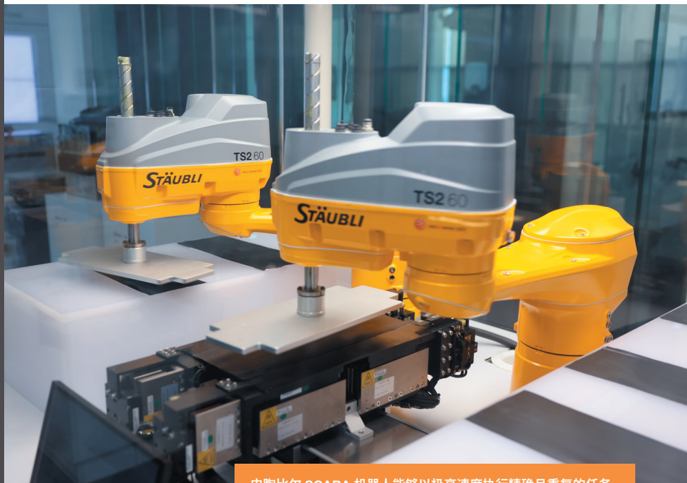
史陶比尔 SCARA 机器人能够以极高速度执行精确且重复的任务
