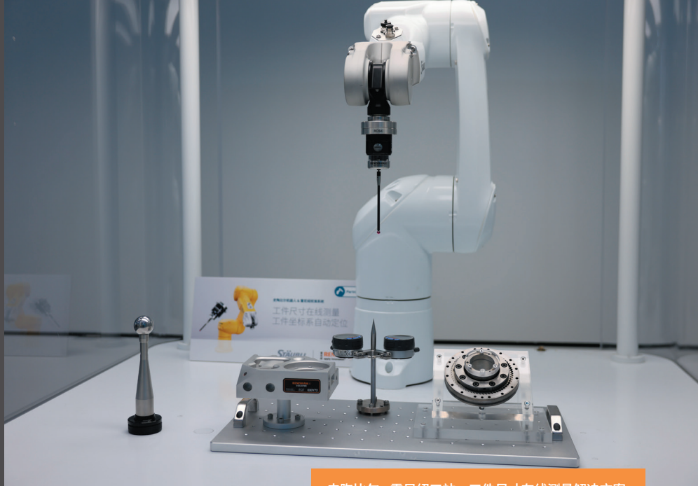
史陶比尔 - 雷尼绍工作站，工件尺寸在线测量解决方案
