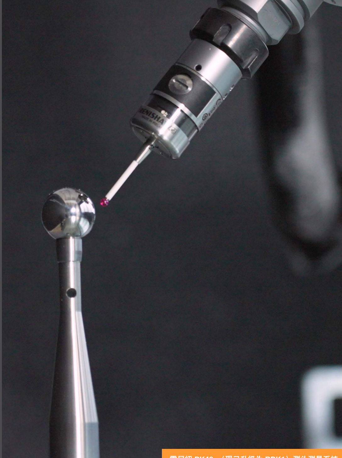
雷尼绍 PK40+（现已升级为 RPK1）测头测量系统
